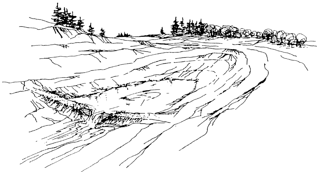
Rycina 13. Zbiornik przechwytyjący spływy powierzchniowe. Może to być zbiornik suchy lub utrzymujący stałe wodę. Są to urządzenia bardzo efektywne w ograniczaniu zagrożeń powodziowych terenów położonych poniżej. Mogą być również wykorzystywane dla celów gospodarczych.
